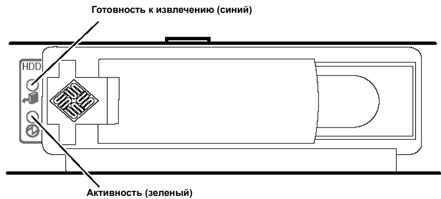
РИС. 1-5 Расположение индикаторов накопителей на жестких дисках
