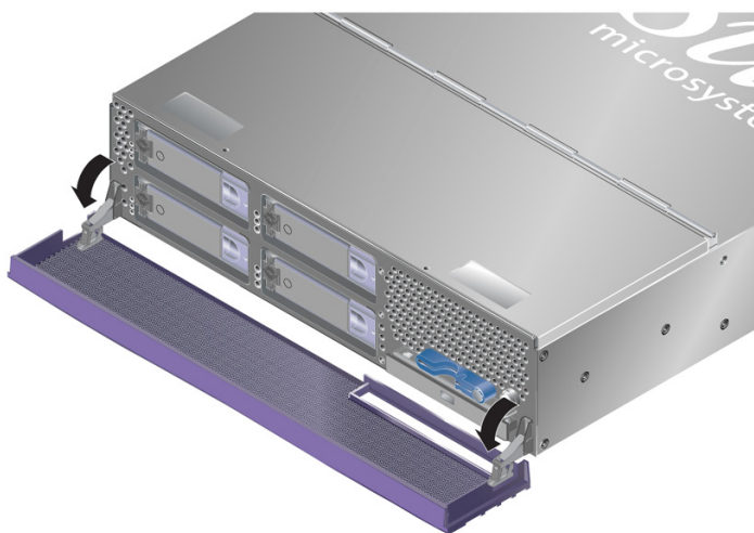
РИС. 2-2 Открывание защитной крышки на сервере Sun Fire V240
