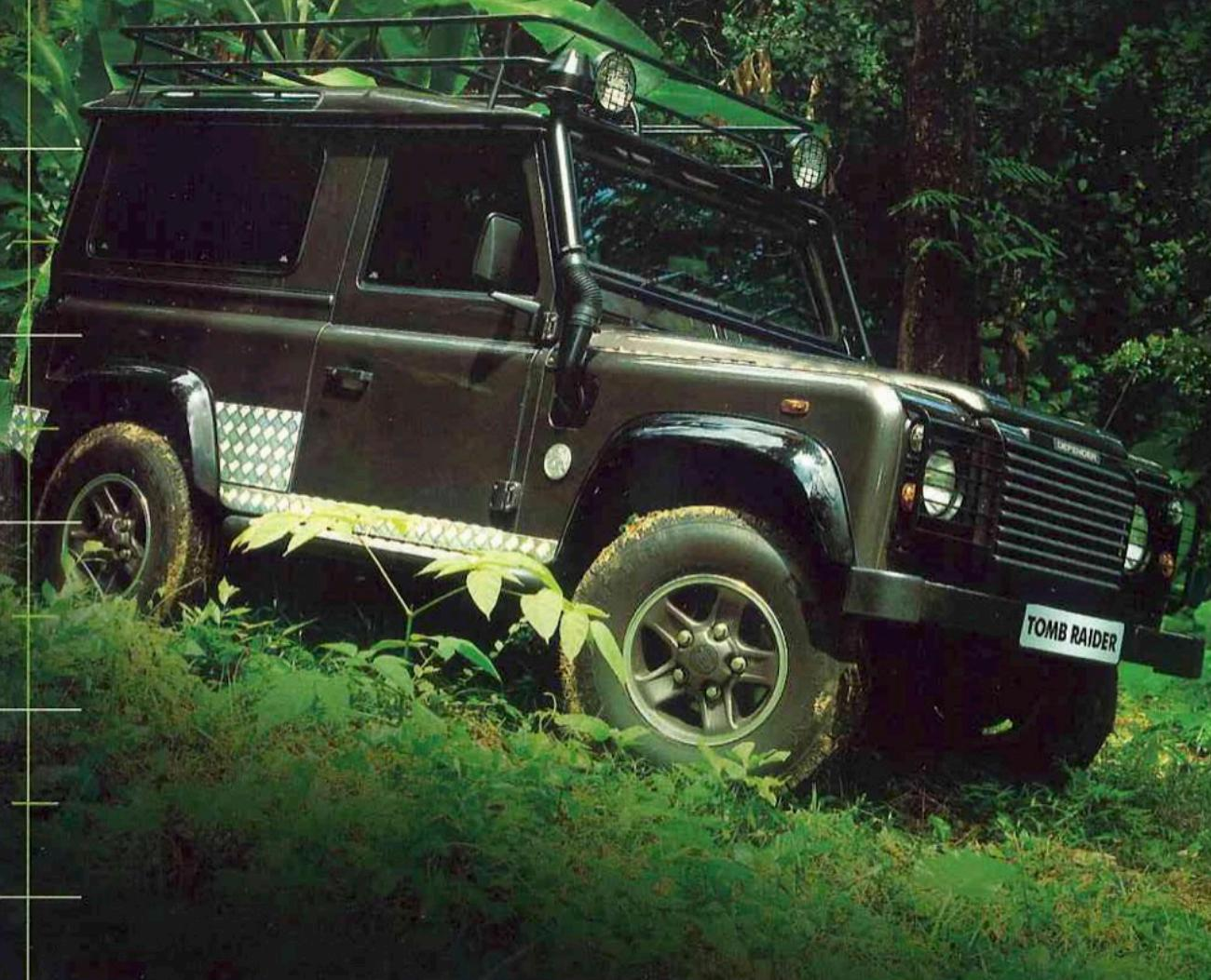
Abbildung zeigt Fahrzeug mit Sonderausstattung: hochgesetzter Lufteinlass, Scheinwerfer-Schutzgitter Front.
