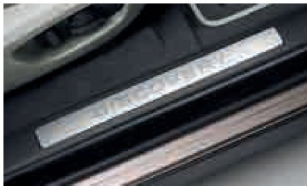
Appliques de seuil finition Brushed Lunar – VPLCS0289LAA Ebony – VPLCS0289PVJ (non illustré) Paire d'appliques de seuil avant avec finition brushed pour ajouter du style à votre véhicule et protéger la décoration du seuil d'éventuelles griffes et éraflures.
