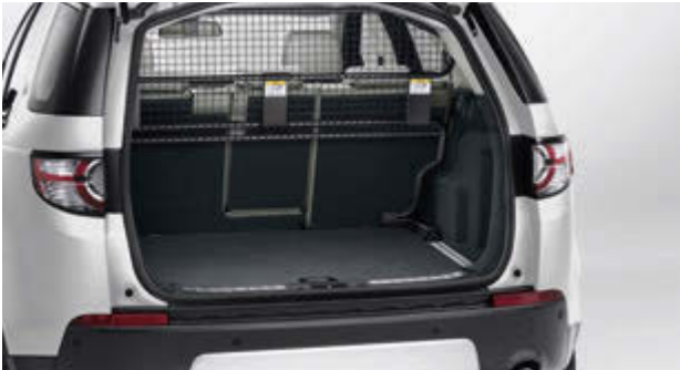
货物分隔板-半高* VPLCS0300 用于防止行李进入客舱。这款货物分隔板针对具有倾斜功能的第二排座椅进行了优化设计。
