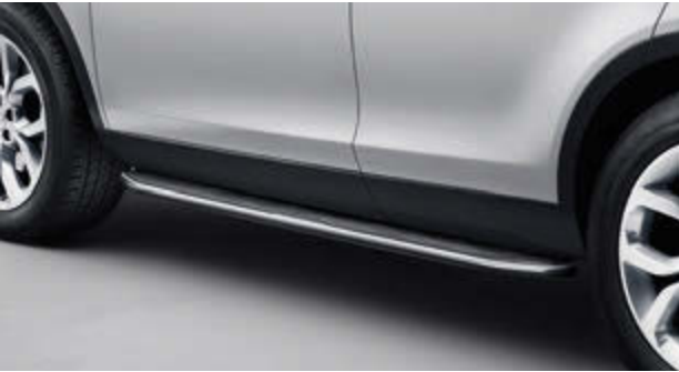
固定式侧踏板** VPLCP0210 侧踏板为上下车辆提供帮助，并提高了车顶的可接近性。设计特征包括光亮的
