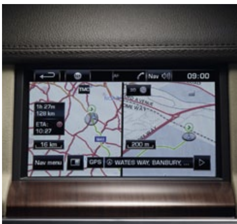
Système de navigation à cartographie sur disque dur avec écran tactile couleur de sept pouces intégré à la console centrale
