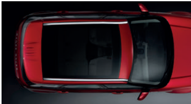
车顶纵梁* Δ VPLVR0085 – 银色饰面 VPLVR0086 – 黑色饰面 车顶镶饰饰面套件 - 全景天窗 VPLVR0089 – 银色饰面 VPLVR0090 – 黑色饰面 车顶纵梁方便安装横杆，从而实现车顶承载。预设定位点可确保横杆安装在理想的重量分布和动力学位置。安装后的车辆高度为1640毫米。最大载重量为71.8千克。
