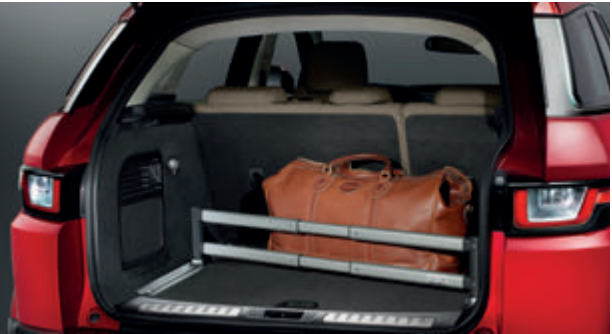
行李箱导轨 Δ VPLVS0102 行李箱导轨增加了行李箱收纳物品的灵活性，可安装行李箱横杆和收纳系统。 行李箱横杆 †Δ VPLCS0324 通过安装于行李箱横杆上的快速锁/放系统附件包，可以为行李箱内的行李和其他物品固定提供灵活的解决方案。该附件包具体包括惯性卷缩式伸缩带、伸缩杆和储物袋。
