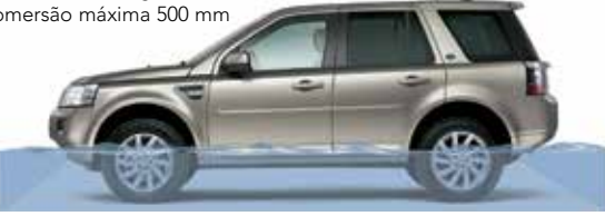
Profundidade na água Submersão máxima 500 mm
