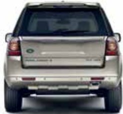
Tração traseira 1.624 mm Largura 2.005 mm com retrovisores rebatidos Largura 2.195 mm com retrovisores abertos
