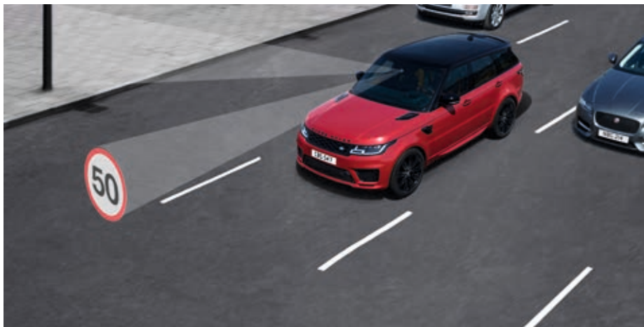
Sistema de reconocimiento de señales de tráfico con limitador de velocidad adaptativo
