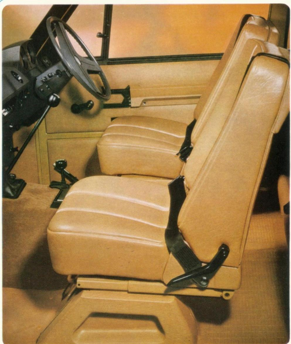
Die vorderen Einzelsitze sind robuste Sicherheitssitze und für den Einbau von Sicherheitsgurten vorgesehen.
