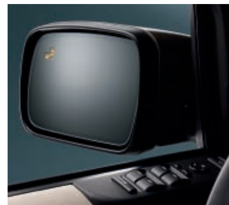
El Sistema de Monitorización del Ángulo Muerto utiliza un radar lateral para advertir de la presencia de vehículos dentro del punto ciego del ojo. Un icono luminoso ámbar se ilumina en el retrovisor exterior del conductor al detectar la presencia de un vehículo.
