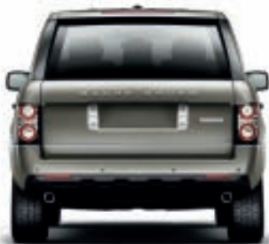
Distancia entre ruedas traseras 1.625 mm Ancho 2.034 mm con retrovisores plegados Ancho 2.216 mm con retrovisores sin plegar
