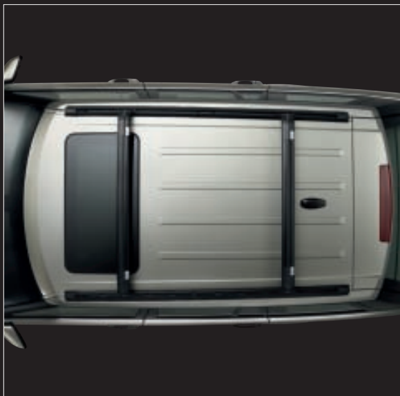
Rieles y barras transversales para el techo* CAB000040PMA Barras transversales ajustables incluidas. Con cierre de protección. Capacidad de carga: 91,6 kg. Altura del vehículo con barras: 1.963 mm.
