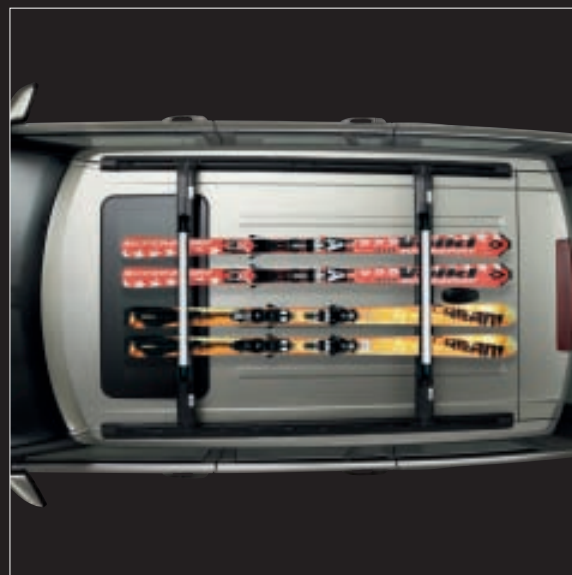
Soporte para esquís y Snowboard* LR006849 Con cierre de seguridad. Permite transportar cuatro pares de esquís o dos snowboards. Incorpora rieles deslizantes para una carga más fácil. Capacidad de carga: 36 kg.
