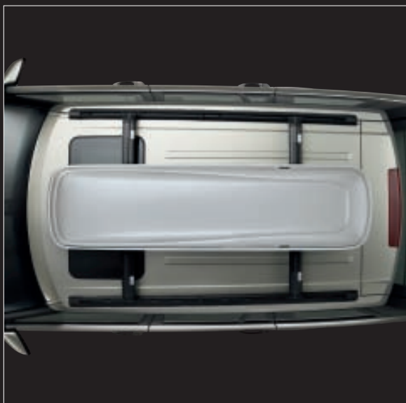
Caja deportiva* VPLDR0002 Puede montarse en ambos lados del vehículo con apertura desde el lateral del vehículo. Sistema de retención interno para esquís u otras cargas largas. Con cierre de seguridad. Dimensiones exteriores: 2.300 mm de largo, 620 mm de ancho y 390 mm de alto. Volumen: 400 litros. Capacidad de carga: 60 kg.
