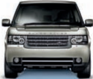
Altura Libre Altura libre debajo del vehículo (todoterreno) 283 mm (Altura estándar de marcha 232 mm)
