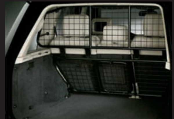
Gepäckraumabtrennung – volle Höhe VUB503890 Leicht zu entfernen. Mit praktischer Skidurchreiche. Kann dennoch mit einziehbarer Laderaumabdeckung ausgerüstet werden. Erfüllt die EG-Verordnung 17. Nicht kombinierbar mit Vertikaljalousie und starrem Laderaumschutz.
